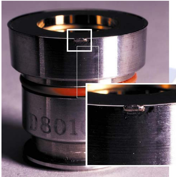
lokaler Verschleiß an Werkzeugeinsatz für CD-Produktion -> lokale Reparatur
